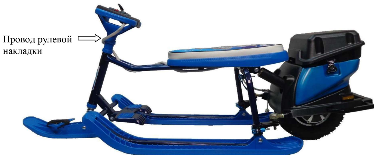
Рис. 8 Присоединение провода рулевой накладки – 5 шаг.
