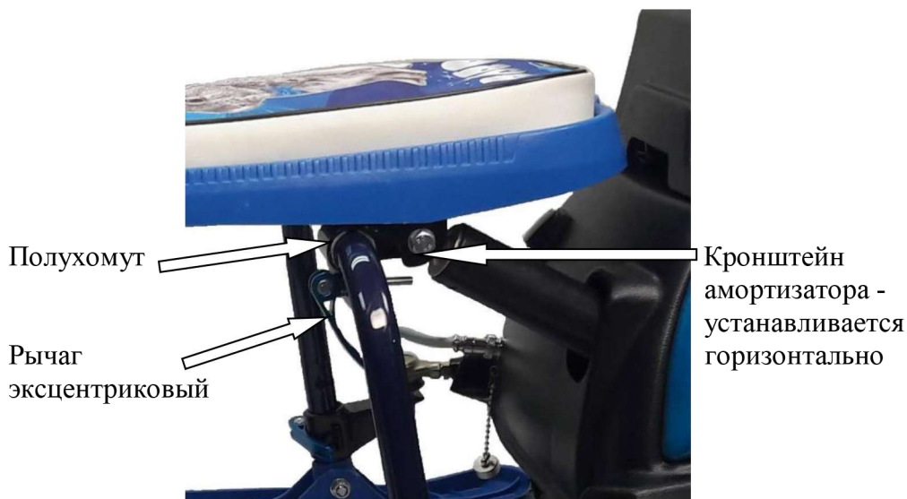
Рис. 6 Присоединение привода к подседельной трубе снегоката – 3 шаг.
